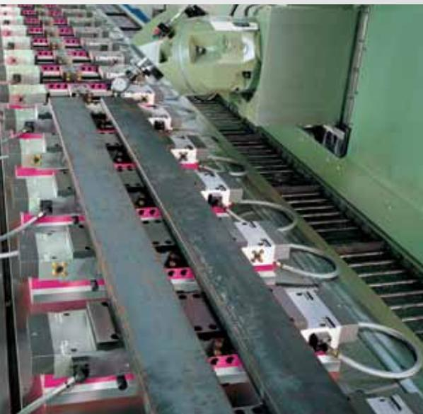
Hydraulische Spannung von Führungsschienen
