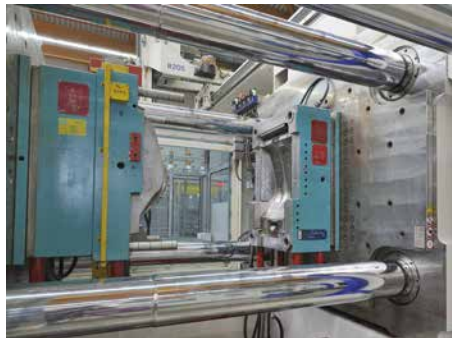
R-MAG-P, mit Quadratpolen für Spritzgießmaschinen bis 300 t
