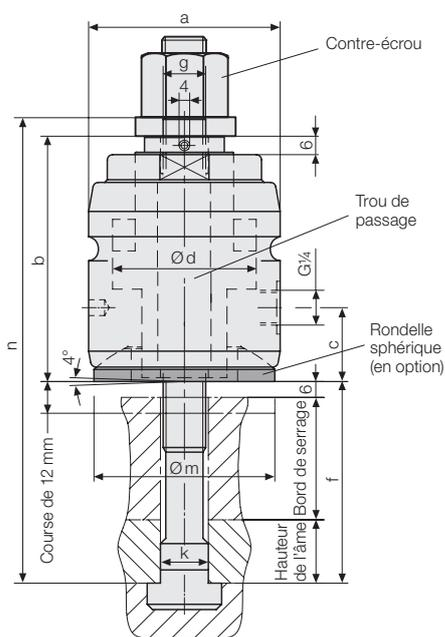
Adaptation libre et flexible aux hauteurs variables des bords de serrage grâce à un ajustage rapide et facile de la tige de traction au moyen d'un contre-écrou.
