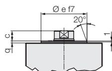
Embase de centrage seulement avec forme de corps RB et RC.
