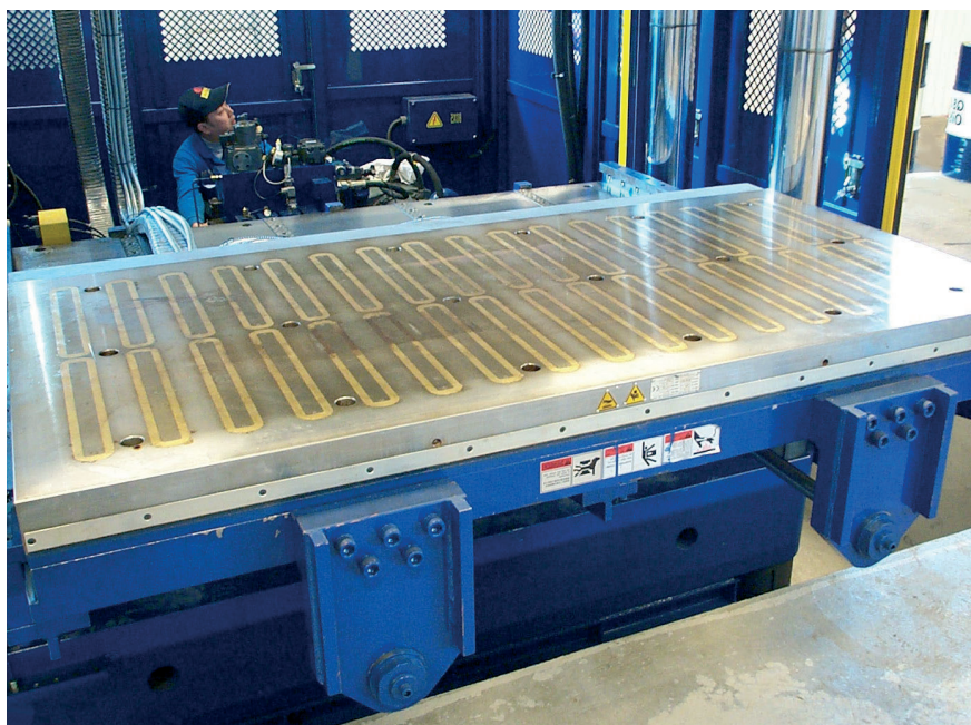
System mocowania magnetycznego w prasie poziomej dla temperatur do 240 °C
