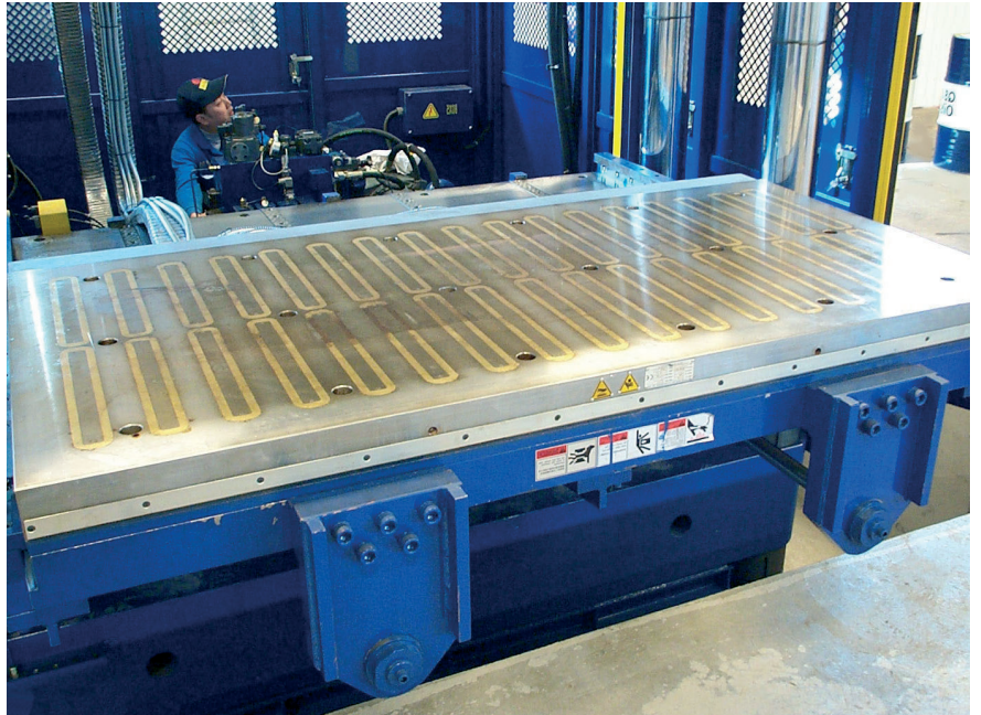
Système de serrage magnétique sur une presse verticale, résistance thermique jusqu'à 230 °C.
