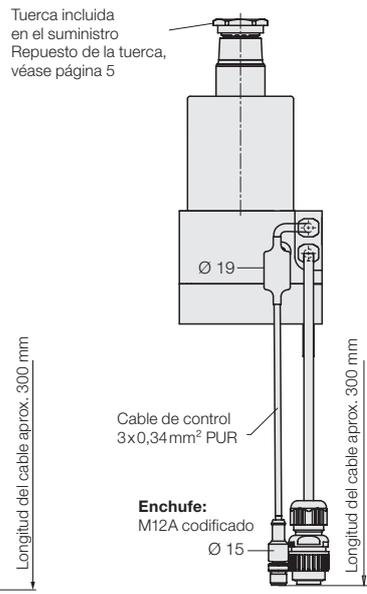
La brida de sujeción puede fijarse en la posición que se desee.
