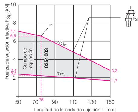
\*\* Con longitudes de brida de sujeción > 75 mm, tener en cuenta los parámetros de ajuste permitidos de la fuerza de sujeción efectiva según las instrucciones de servicio.
