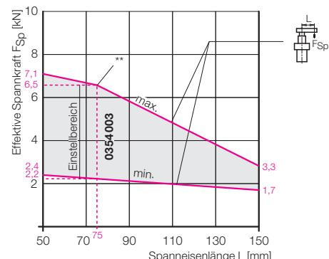
\*\* Bei Spanneisenlängen > 75 mm bitte die zulässigen Einstellparameter der effektiven Spannkraft nach Betriebsanleitung berücksichtigen.
