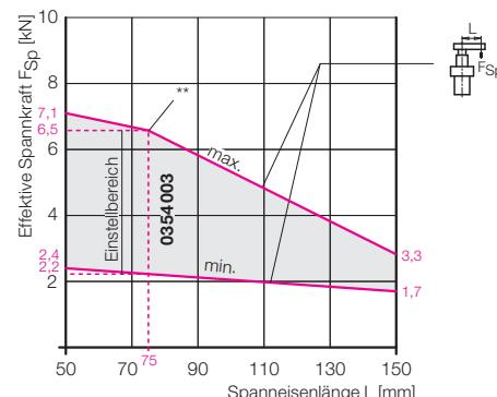
\*\* Bei Spanneisenlängen > 75 mm bitte die zulässigen Einstellparameter der effektiven Spannkraft nach Betriebsanleitung berücksichtigen.
